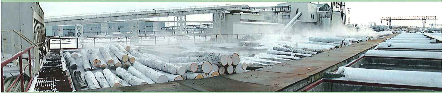
Бассейн гидротермической обработки сырья. The pool of hydrothermal processing of raw materials.
