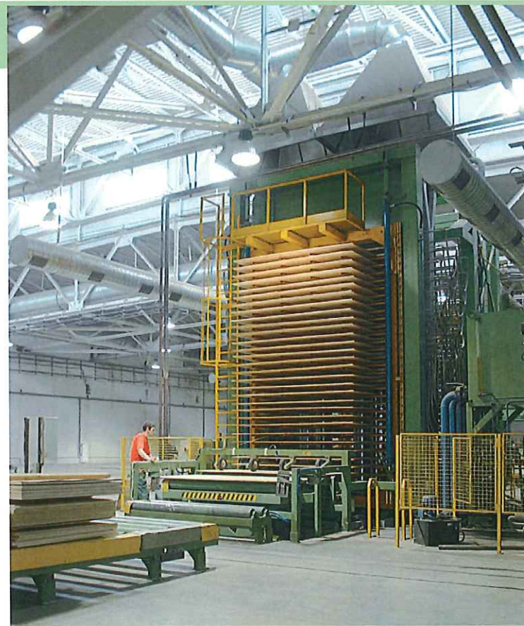
30-ти этажный горячий пресс с автоматизированными загрузочным и разгрузочным устройствами. 30 – storied hot press with automated filling and discharge devices.
