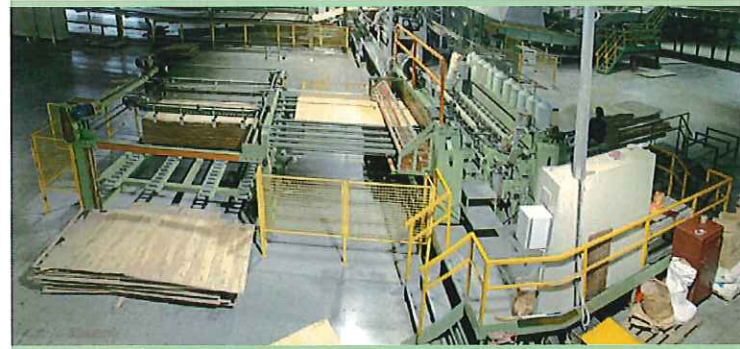
Линия рубки и ребросклеивания сухого шпона. Функции этой линии позволяют кусковой — неформатный шпон превращать в полноформатный, что является залогом выпуска качественной продукции.
