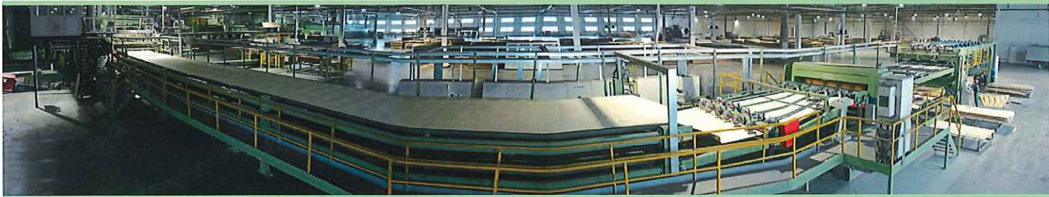
Линия лущения и штабелирования сырого шпона. Peeling and stacking line of raw veneer.
