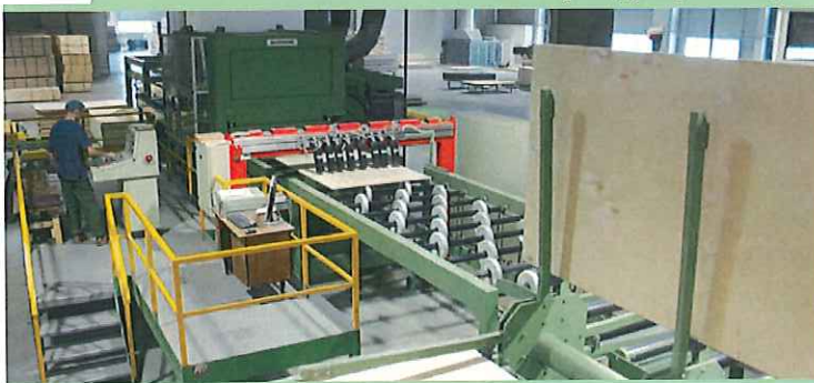
Автоматизированная линия шлифовки, сортировки и штабелирования фанеры. Automated line of grinding, grading and stacking.
