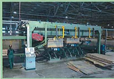
Автоматическая станция штабелирования сырого шпона. The automatic stacking station of raw veneer.
