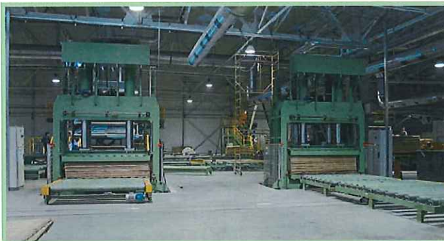
Прессы для холодной подпрессовки пакетов, придающие «растушённой» пакету фанеры компактность, обеспечивающую их беспрепятственную загрузку в горячий пресс.
